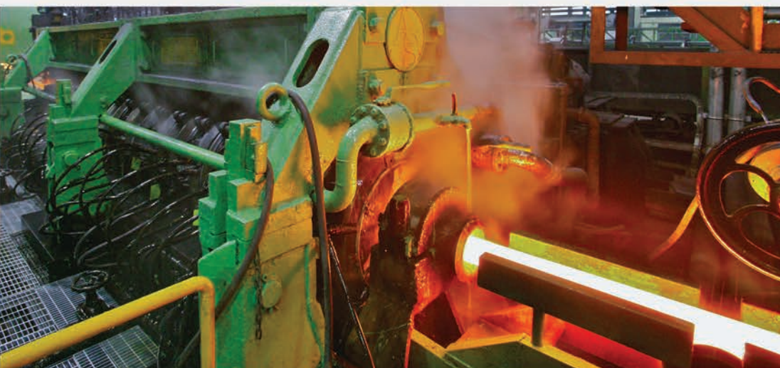
Foto 1: Dal pulpito del laminatoio a caldo, vista taglio volante Photo 1: From the stretch-reduction mill pulpit, view of the flying shear
