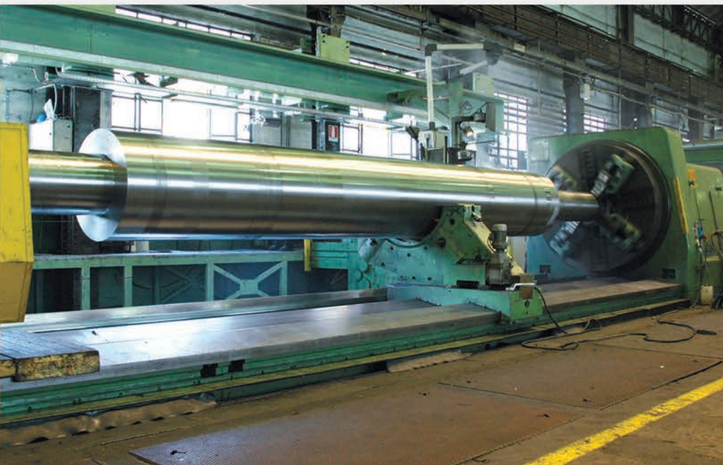
4 Foto 4: Tornio orizzontale a controllo numerico Photo 4: Horizontal, numerically controlled lathe
