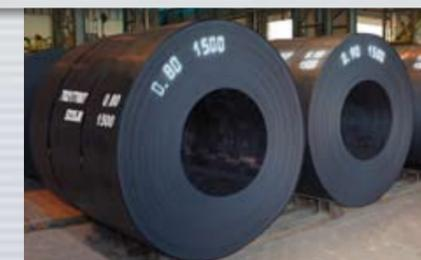
I prodotti coprono la più ampia gamma di acciai e di spessori fino agli ultrasottili a caldo (0,8 mm) che sostituiscono per molte applicazioni il rillaminato a freddo.
