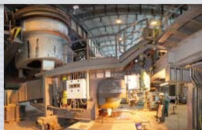
L'acciaio liquido viene colato in bramma sottile tramite il sistema lingottiera (brevettato da Arvedi) per ottenere le migliori caratteristiche qualitative con elevata affidabilità.
