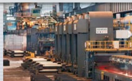
Il nastro intermedio, viene opportunamente riscaldato nel forno ad induzione, primo esempio al mondo, e successivamente ridotto allo spessore finale tramite il laminatoio finitore che opera a temperatura e velocità costanti per ottenere le migliori caratteristiche del prodotto.
