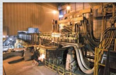
Un forno elettrico Consteel (capacità allo spillaggio di 250 ton) alimenta la linea ESP con acciaio liquido con le più precise caratteristiche di analisi e purezza.
