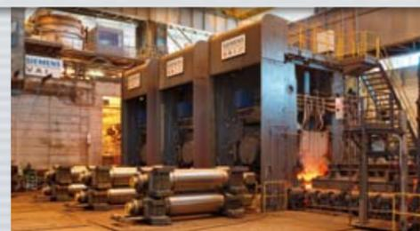
Una innovazione di valore epocale: la connessione diretta di colata e laminazione. La bramma sottile all'uscita della lingottiera viene ridotta di spessore a cuore liquido e laminata direttamente a temperatura elevata per ottenere un nastro intermedio di alta precisione e con struttura omogenea.
