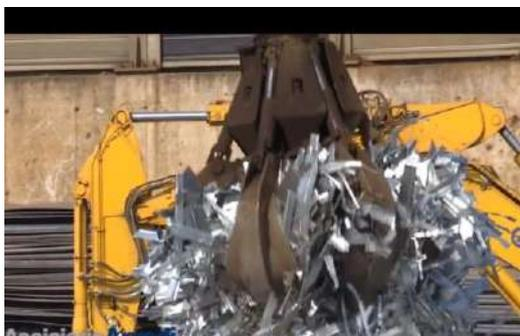
Recupero di rifiuti di origine esterna costituiti da rottami ferrosi presso il parco rottame e specifiche aree di gestione dotate di specifici impianti di selezione, trattamento e riduzione volumetrica al fine di eliminare le frazioni estranee e produrre materia prima utilizzabile presso i due forni EAF per la produzione di acciaio.
