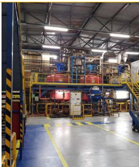
Trattamento dell'acido cloridrico esausto in uscita dai due impianti di decapaggio per ottenere una serie di prodotti con specifica commerciale, quali cloruro ferrico e cloruro ferroso, che trovano impiego nei processi di depurazione e potabilizzazione delle acque ad uso civile e industriale.
