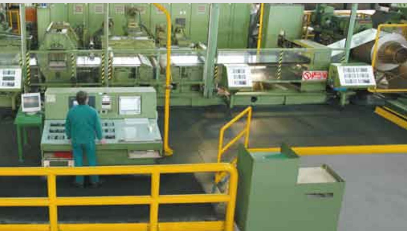
Slitter di precisione SUNDWIG a tavola 1270 mm.
