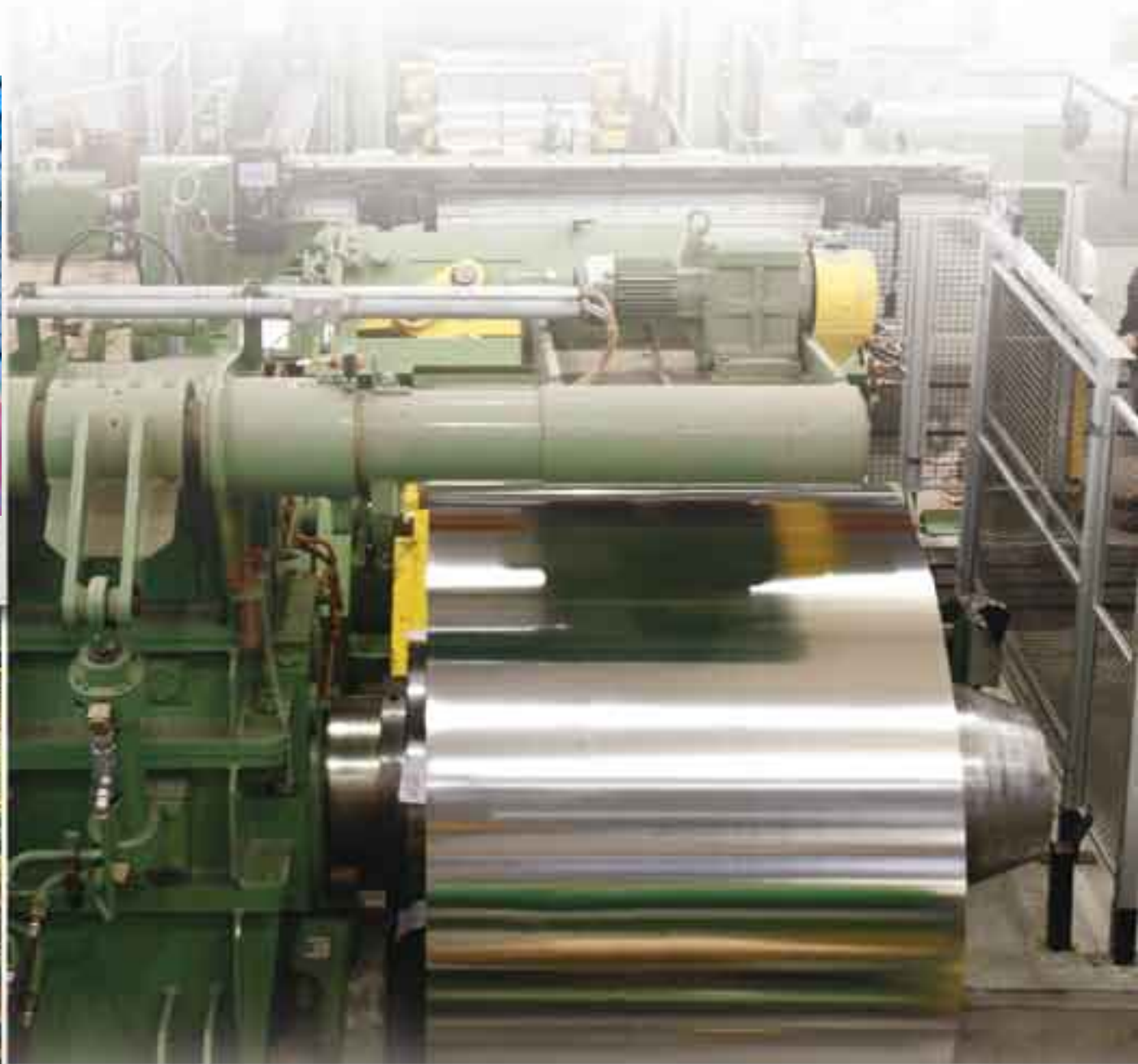
Slitter di precisione SUNDWIG a tavola 1270 mm.
