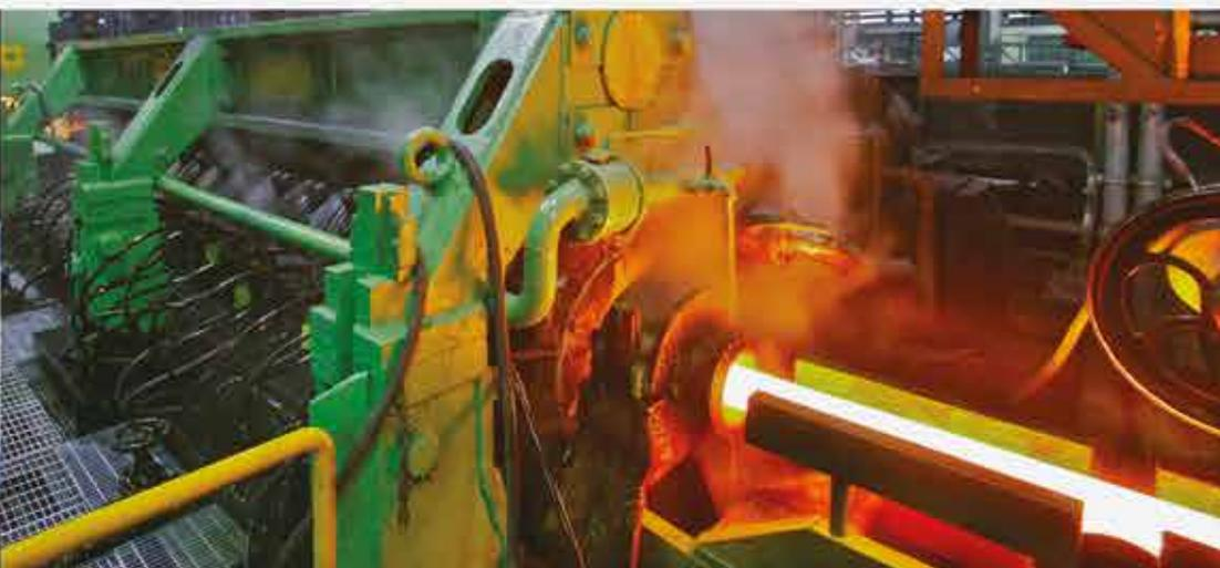
Foto 1: Dal pulpito del laminatoio a caldo, vista taglio volante
